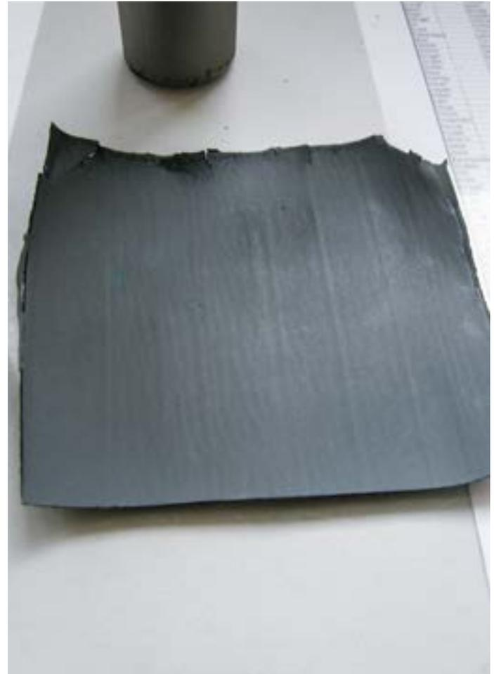
Stark aufgebaute Haftvermittler-Rückstände können im Ganzen abgelöst werden.
