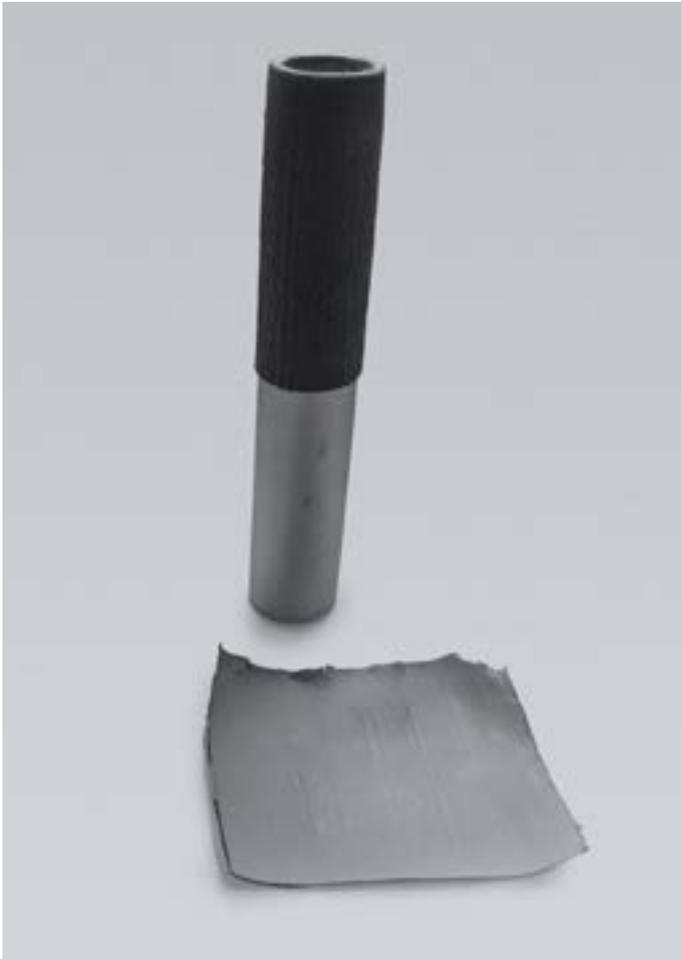
Vom beschichteten Teil des Zylinders lassen sich Verschmutzungen restlos entfernen.
