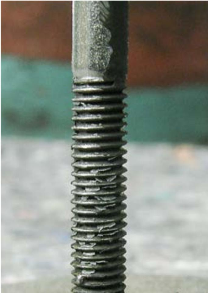
Vorher: Das Gewinde ist durch Produktionsrückstände stark verschmutzt.
